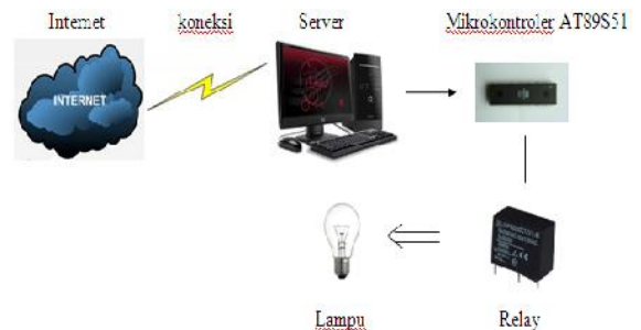
Gambar 5: Blok diagram Sistem kontrol lampu otomatis berbasis Web
